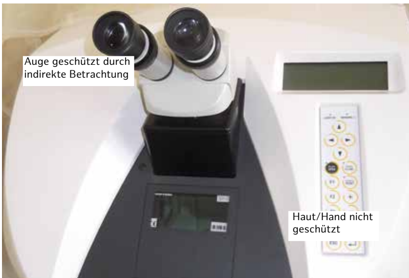
Abb. 47: Teilumschlossenes Nd: YAG Laserschweißgerät Klasse 4 im Dentallabor mit Werkstückpositionierung von Hand, Quelle: BGV
