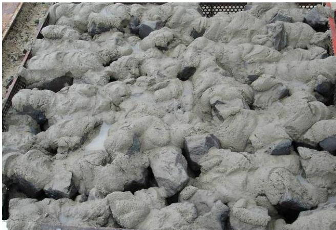
*Bild A4-6: Versuchskasten eines sachgerecht hergestellte teilvergossenen Deckwerks (90 l/m<sup>2</sup>, LMB<sub>5/40</sub>, streifenförmiger maschineller Einbau)*
